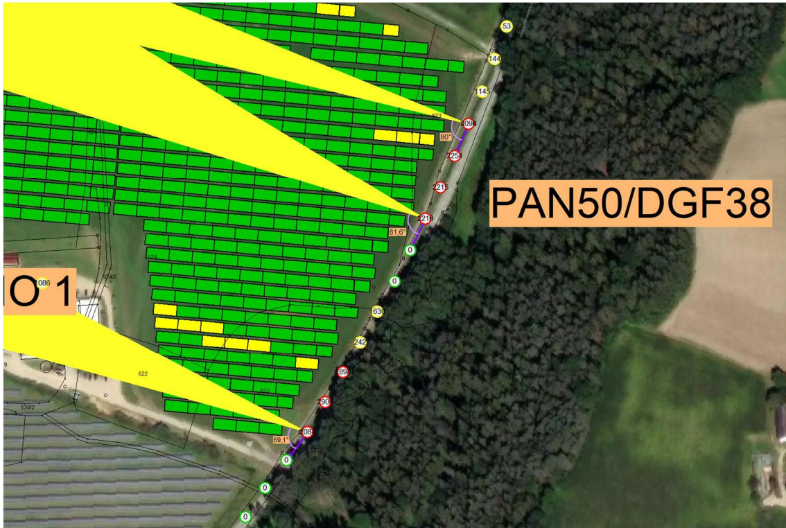
Abbildung 4.2: Blickwinkelanalyse der Kreisstraße (gelb: Reflexionsstrahlen, violett: Fahrtrichtung)
