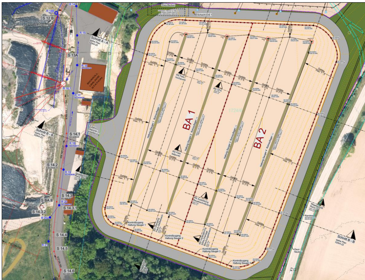
Abbildung 3: Lageplan der Deponieerweiterung – OK Basisabdichtung
